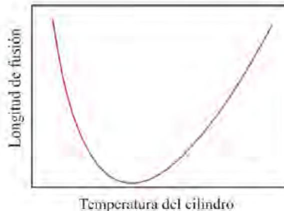
**Figura 18.** Relación entre la longitud de fusión y la temperatura del cilindro para una velocidad del tornillo constante.
