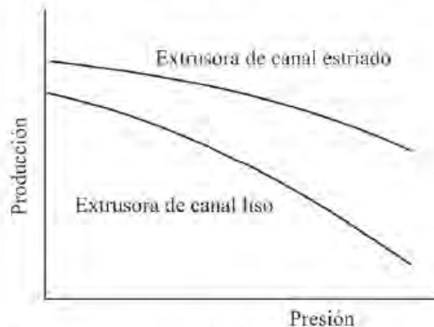
**Figura 14.** Representación del caudal de salida frente a la presión, para un cilindro liso y para uno estriado.
