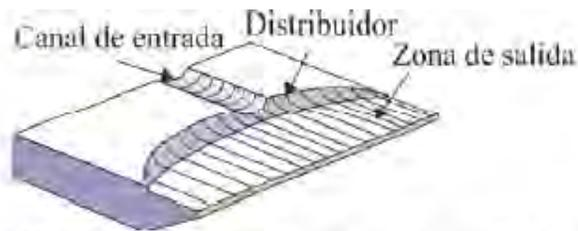
**Figura 11.** Partes diferenciadas en una boquilla de extrusión.
