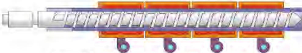
**Figura 5** Sistema cilindro de calefacción-tornillos
